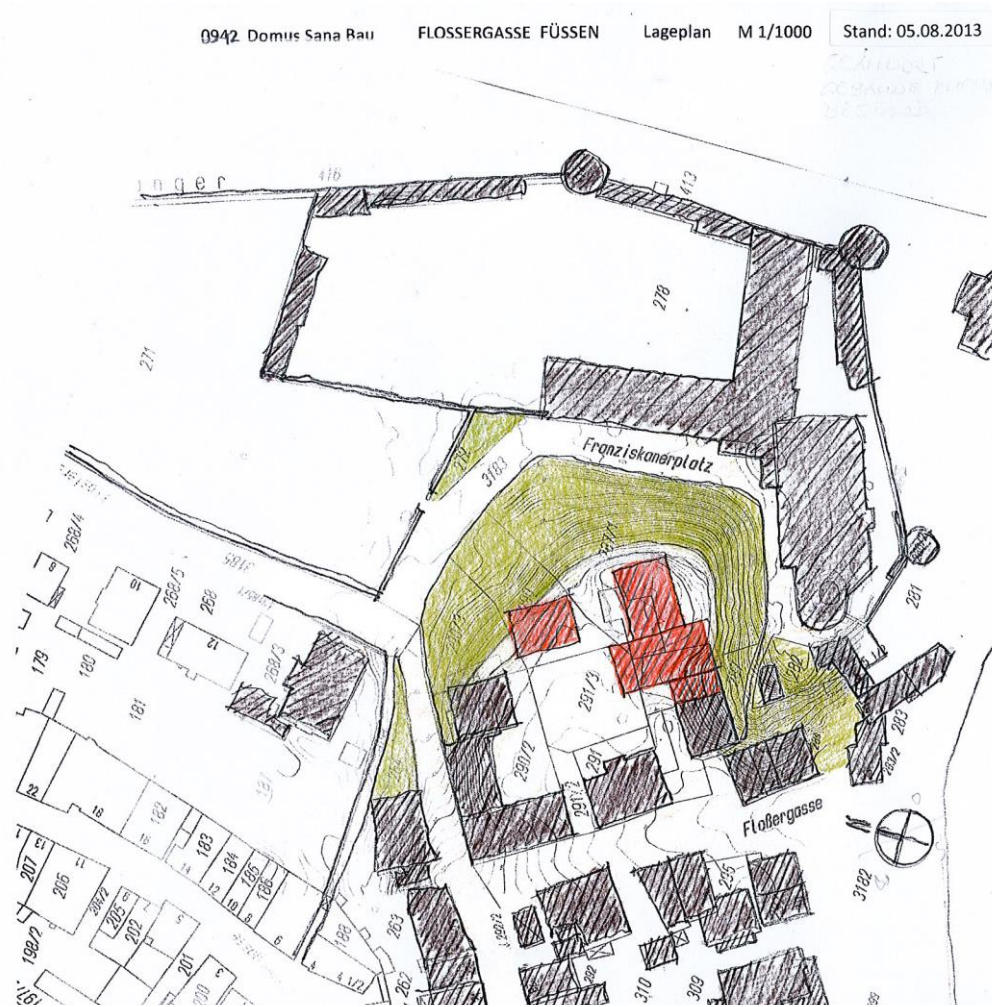
Abbildung 3: Lageplan mit der gewünschten orthogonalen Bebauung – mit roter Farbe markierte Gebäude und hellgrün markierte Hangzone
